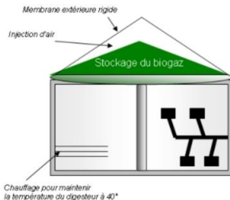
Figure 9 Représentation d'une cuve de méthanisation (digesteur)
